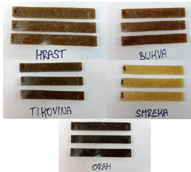
Slika 1. Uzorci drvno-plastičnih kompozita za ispitivanje mehaničkih svojstava
