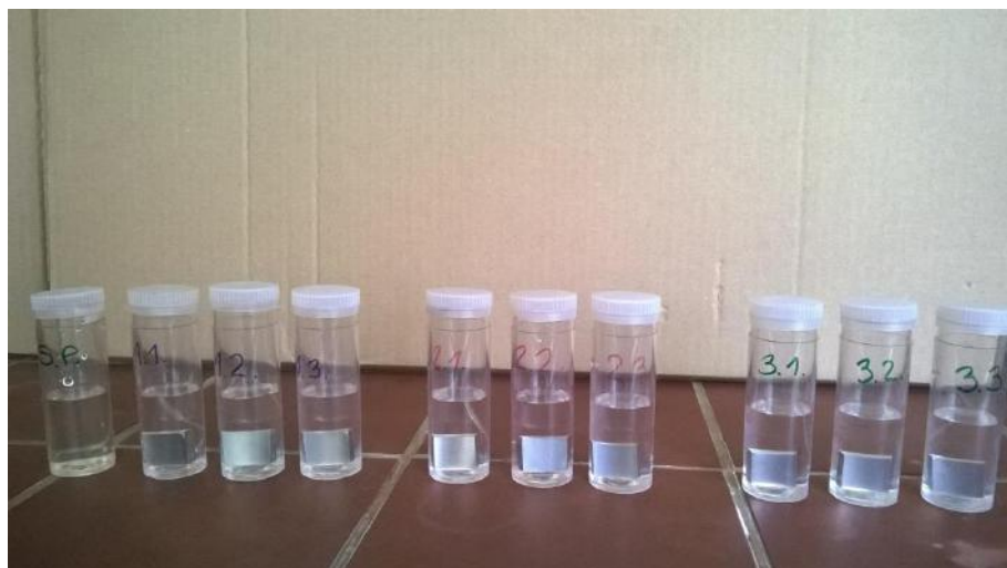
Slika 4. Postupak izlaganja uzoraka 3,8 %-tnoj otopini NaCl
