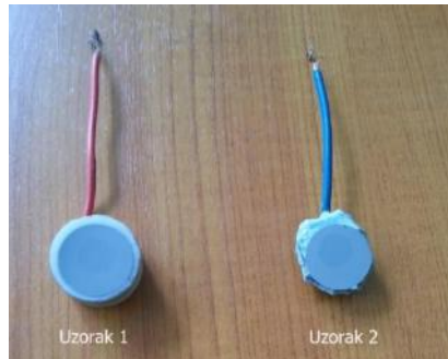
Slika 2. Ispitni uzorci od WC-Co tvrdog metala
