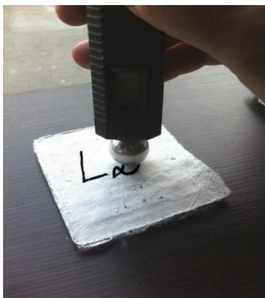
Slika 3. Mjerenje vlažnosti sadrene pločice [2]
