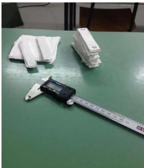
Slika 8. Mjerenje dimenzija ispitnih epruveta
