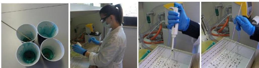
Slika 4. Priprava smole (a); nanošenje kapljica smole na vlaknati supstrat (b)
