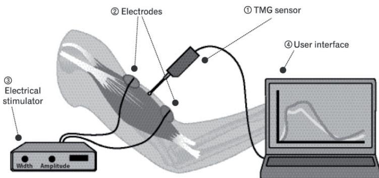
Slika 1. Pojednostavljeni prikaz TMG mjerena.
