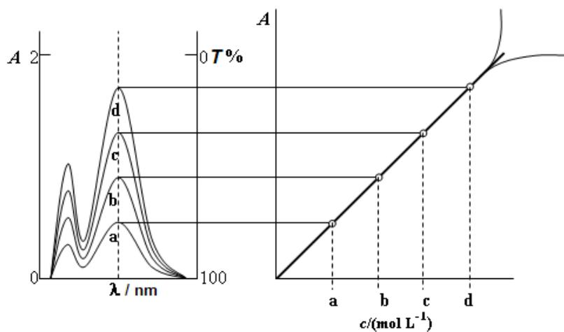
**Slika 1.4. Apsorpcijski spektri standardnih otopina različitih koncentracija; baždarni pravac i odstupanja od baždarnog pravca.**
