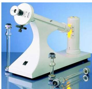
Polarimetar i polarimetrijske kivete
