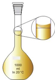
Slika prikazuje odmjernu tikvicu. Na svakoj odmjernoj tikvici je oznaka volumena na vratu koja se u staklo utiskuje fluorovodičnom kiselinom. Također, na odmjernoj tikvici uvijek treba pisati koliki joj je obujam (volumen) i pri kojoj je temperaturi baždarena.
