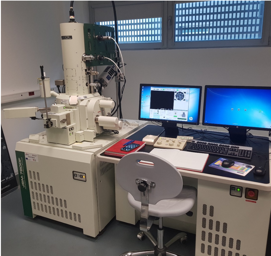
Slika 17. Pretražni elektronski mikroskop SEM (JSM-7800 F Schottky Field Emission Scanning Electron Microscope, JEOL Ltd., Tokyo, Japan).
