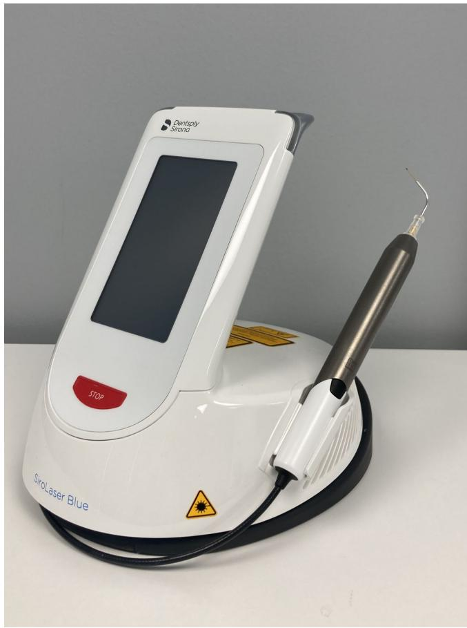
Slika 5. SiroLaser Blue kompanije Dentsply Sirona prvi je diodni laser s mogućnošću emitiranja plavog svjetla u pulsnom načinu prikladnom za fotodinamsku terapiju površine implantata.
