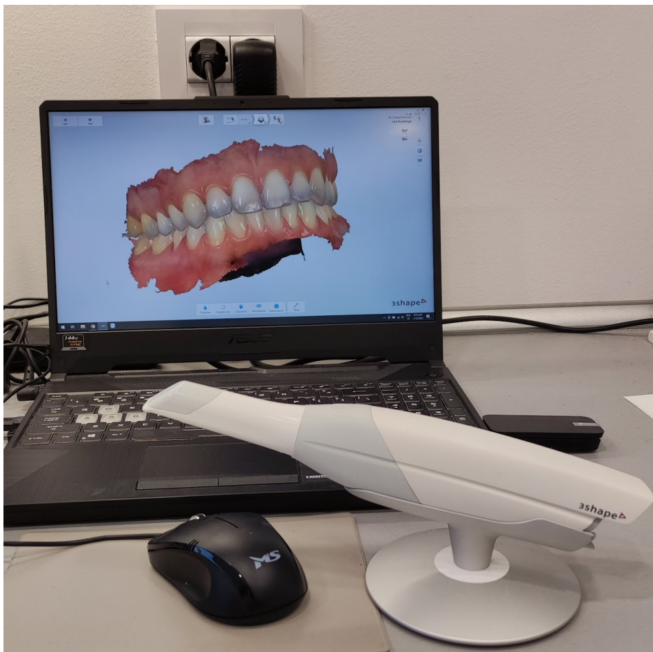
Slika 4. Intraoralni skener 3shape – izvorno autorsko djelo
