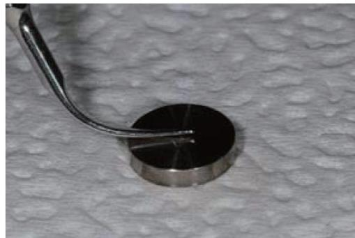
Slika 26. Postupak testiranja nastavka na titanskom disku. Preuzeto s dopuštenjem autora:
