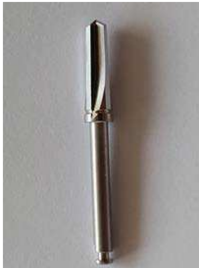
Slika 5. Profilno svrdlo za oblikovanje ležišta implantata
