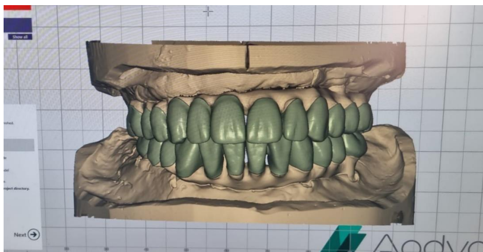
Slika 19. Postupak oblikovanja pojedinačnih krunica u programu Exocad.
