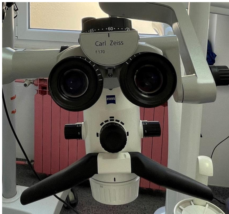
Slika 6. Oznaka fokalne udaljenosti leće tubusa (170 mm).
